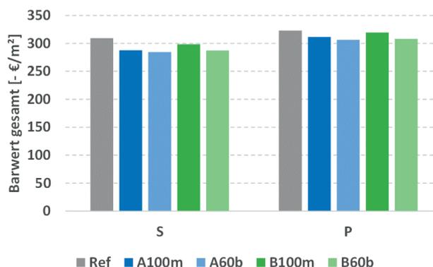
Abbildung 15: Barwert verschiedener Sanierungsmaßnahmen an der Gebäudehülle für alle untersuchten Sanierungsstufen der Baualtersperiode 1958-78 für MMH
